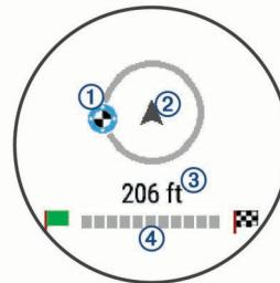
Индикатор пункта назначения ① показывает направление к пункту назначения относительно направления вашего движения ②. Если индикатор пункта назначения отображается в верхней части круга, вы двигаетесь прямо к пункту назначения. Оставшееся расстояние до пункта назначения ③ отображается под кругом. Стока выполнения ④ отражает выполнение навигации к пункту назначения.
